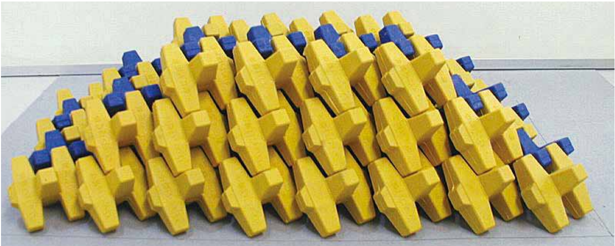
A) 急勾配方式 正面写真 (天端3個並び3層)
